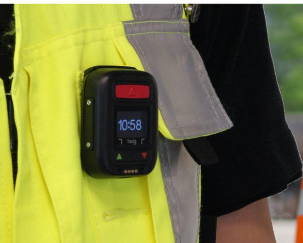
La scelta preferita degli addetti alla manutenzione è quella di indossare TWIG Neo sulla cintura o sulla tasca fissandolo saldamente con clip da cintura
